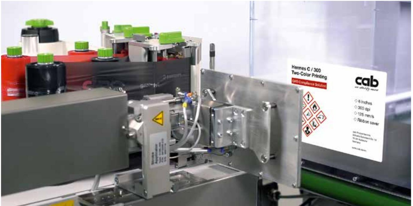
Mit den beiden direkt hintereinander angeordneten Druckwerken werden die Etiketten in Echtzeit, ohne Materialverlust auch bei Einzeletiketten, bedruckt und gespendet.
