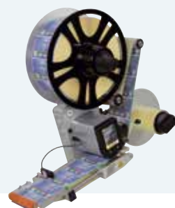
Etikettenspender IXOR zum Einbau in Etikettiermaschinen
